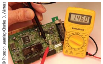
Multímetro digital aplicado para medir un voltaje a través de un elemento de circuito.
